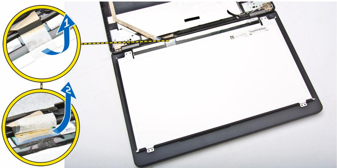
5. Desconecte o cabo eDP de seu conector [1] e remova o painel da tela do conjunto da tela [2].
