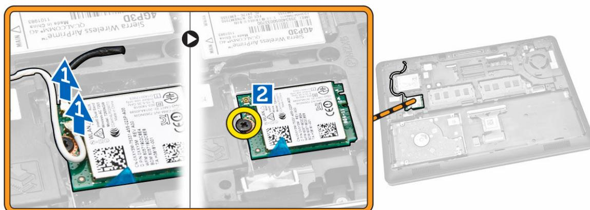
4. Remova a placa WLAN do computador.
