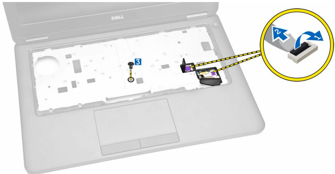
5. Levante o apoio para as mãos em suas bordas para liberar [1] e remova o apoio para as mãos do computador [2].
